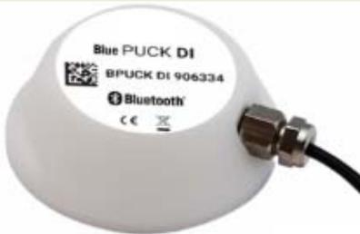
Entrada digital, detección de estado alto: de 2,1 V a 3 V
